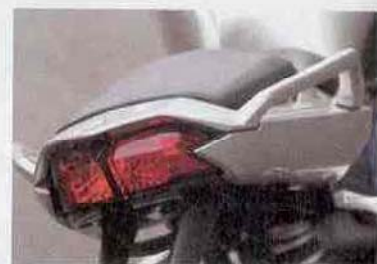
Op de buddy van de Fazer zitten twee handgrepen voor de passagier.
